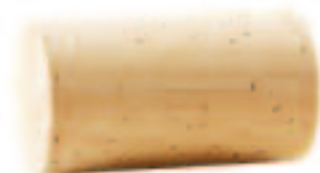
tappo multipezzo in sughero naturale (detto anche accoppiato o compensato), costituito da due o più pezzi di sughero uniti da un collante. Il sughero proviene da piante a crescita lenta, di basso spessore, e conferisce al tappo una densità elevata
