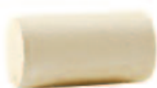
tappo monopezzo in sughero naturale colmatato sottoposto ad un trattamento superficiale mediante l'uso di polvere di sughero mista a collante, che ha lo scopo di eliminare le imperfezioni superficiali del tappo
